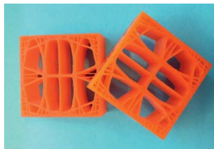
РИСУНОК 1. Вверху: геометрия элементарной ячейки. В центре: результаты моделирования — механические нагрузки в оптимизированной модели; жесткость в двух направлениях отличается в два раза. Внизу: образцы, полученные с помощью 3D-печати.
