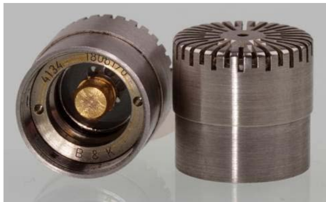
РИС. 1. Слева: фотография микрофона 4134 с защитной решеткой, установленной над мембраной. Справа: вид типового капсуля микрофона в разрезе, где показаны его основные компоненты.
