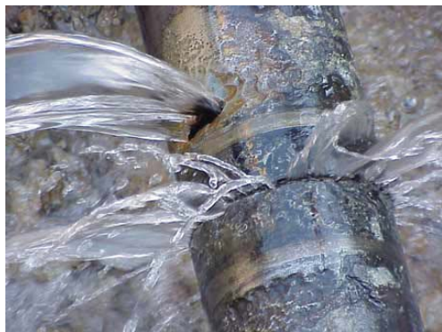
РИС. 1. Слева: исследуемая труба с утечкой. Справа: схема обнаружения утечки. По обе стороны от места утечки устанавливаются два датчика, расстояние между которыми равно D . Шум от утечки распространяется в обе стороны, а коррелятор измеряет время, за которое он достигает каждого датчика. Зная скорость распространения звука по трубам, можно определить точное местонахождение утечки.
