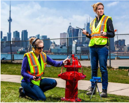
РИС. 2. Компактный и простой в применении корреляционный течеискатель LeakFinderST™.
