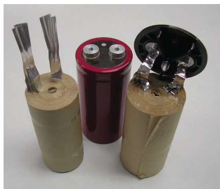
РИС. 1. Алюминиевые электролитические конденсаторы. Обкладки состоят из алюминиевой фольги и целлюлозных сепараторов и демонстрируют анизотропную теплопроводность.
