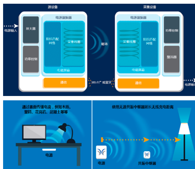
图 1: 上: WiTricity 技术背后的概念, 包括线圈、控制电源输出和管理的电子设备、用于保证电源和采集设备之间正确电源输出的无线通讯。下: 此项技术支持通过不同的材料表面进行充电 (左); 可以通过谐振中继器延长无线充电距离 (右)。
